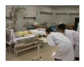
医療の現場で一般的に使われていポータブルX線装置を用いて一般病室で撮影を行う際に、周りにいるヒトはどのくらいの量の散乱線に被ばくするのか測定します。
